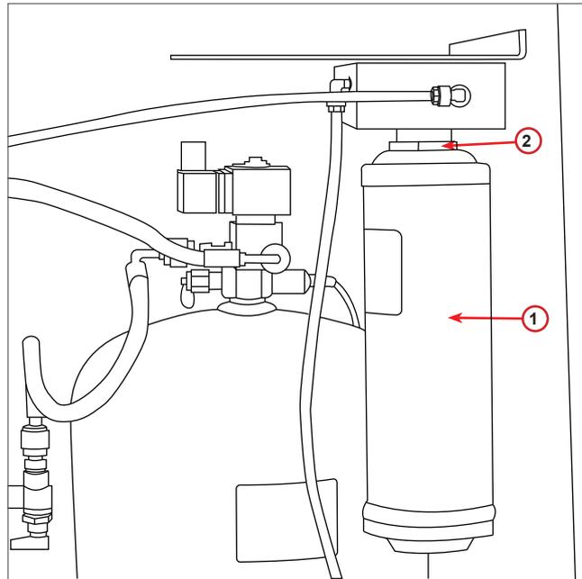
fig. 010 Sustitución del filtro
